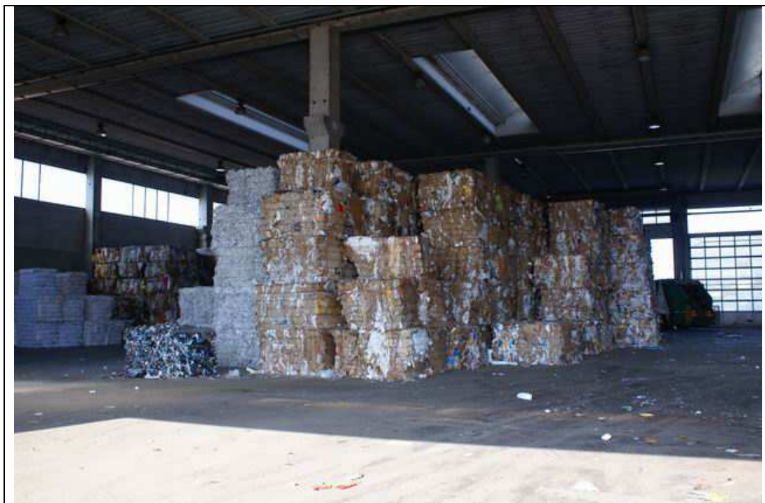
FOTO 3.5: Interno del capannone, area adibita allo stoccaggio delle materie prime seconde, a fine del processo di recupero, disposte in balle.
